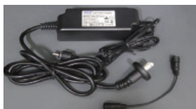
防滴型 AC/DC アダプタ (DC12V/15W/1.25A) (オートフェードストリング 1 本まで)
